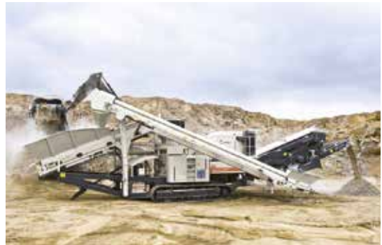
Lokotrack® LT200HPS™ konik kırıcısı, bir ya da iki katlı sökülebilir eleklerle donatılabilir.
