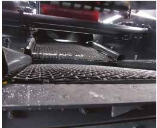
Çift eğimli elek, verimli ve hassas ayırıştırma sağlar.
