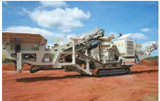
Lokotrack LT300HP konveyörlü besleme ya da titreşimli ızgaralı besleme sistemi ile sipariş edilebilir.
